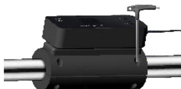
第三步 將機身部份安裝到上管夾的卡槽中，並擰緊螺絲。
